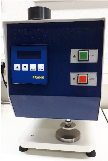
Dickenmesser, Fa. Frank – PTI Bestimmung der Dicke und Zusammendrückbarkeit (4 – stellig) inkl. Auswertung und Messprotokoll
