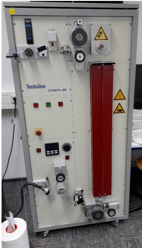
Dynafil ME, Fa. Textechno Bestimmung von Schrumpf- und Kräuselkrumpfkraften z. B. an BCF Teppichgarnen
