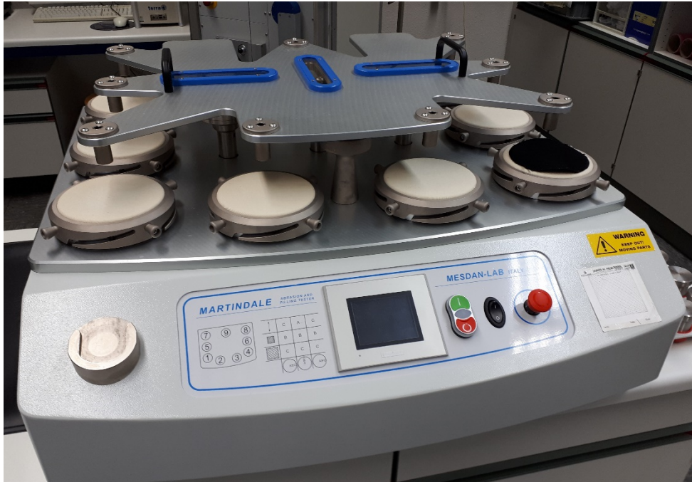
Martindale Scheuer- und Pillingtester Fa. Mesdan Mit 9 Probenhaltern
