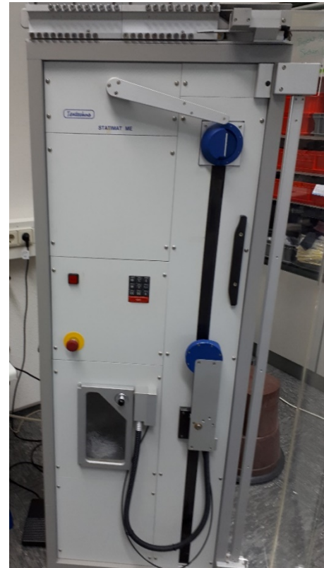
Statimat ME, Fa. Textechno Bestimmung von Höchstzugkraft und -dehnung von Garnen und Zwirnen mit automatischem Spulenwechsel
