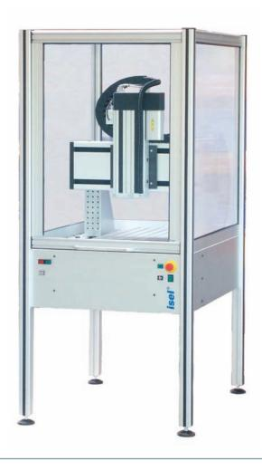
Die isel-CNC-Basiseinheiten der Serie GFM 4433 sind CNC-Maschinen in stabiler Gestellbauweise aus Leichtbauprofilen.
